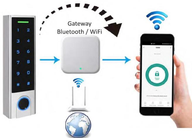
Con l'ausilio del Gateway opzionale SUN-MESH è possibile interagire con il lettore SUN-PROXY2 anche da remoto, tramite connessione Internet.
